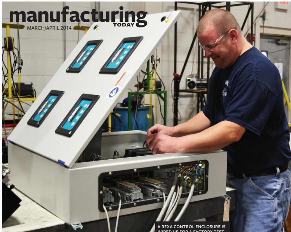
A REXA CONTROL ENCLOSURE IS WIRED UP FOR A FACTORY TEST.
