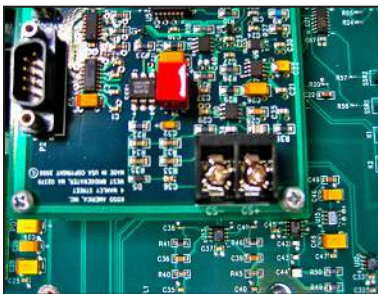
Photo 4.E.13.1-3 Terminals CS- and CS+
