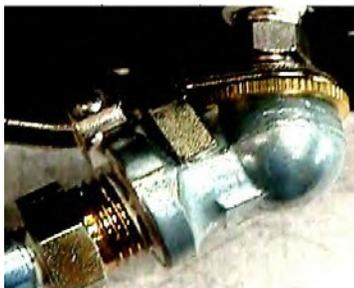
**Figura 1.6.4-6 Válvula de Enchimento com encaixe Schrader.**
