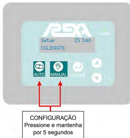
**Nota:** Se o atuador for golpeado além do limite de cilindro configurado na fábrica, a tela mostrará **CylEnd** (FinalCil) enquanto a tecla para baixo é pressionada. Se a tecla Enter for pressionada, a tela mostrará **TooLow** (MuitoBaixo). **Position Lo** (Posição Ba) precisará ser calibrada mais alta até que esse aviso desapareça.
