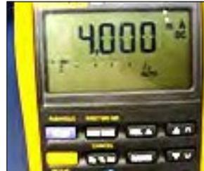
**Xmitter Hi** {Transmissor Alto} é o parâmetro para calibrar o alcance da Saída do Transmissor de Posição de 4-20 mA.
