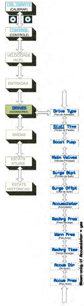
**Main Valves** (Válvulas Principais) define o desvio máximo permitido antes que as válvulas principais sejam abertas. Este é um parâmetro especial; apenas usado com atuadores que utilizam um acumulador para toda a força motriz (sem módulo de energia).
