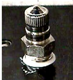
Figura 1.6.4-2 Válvula de Enchimento com cobertura.
