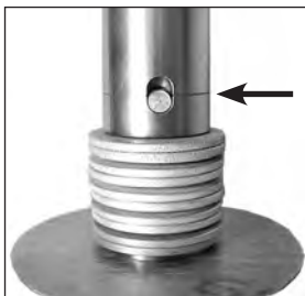
Figura B.2-1 Acoplamento Pré-carregado
