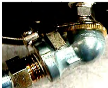
Figura 1.6.4-6 Válvula de Enchimento com encaixe Schrader.
