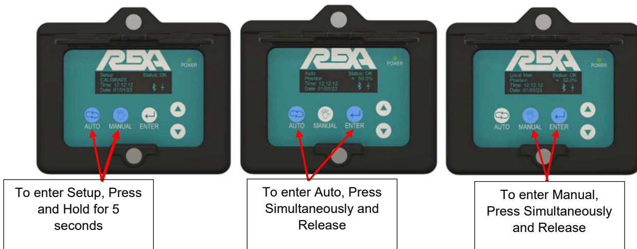
Figura 39: Modos de operação
