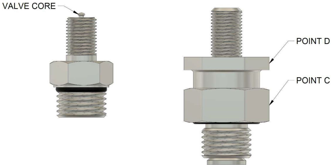
Figura 11A: Localizador do núcleo da válvula de gás Figura 11B: Núcleo da válvula de gás
